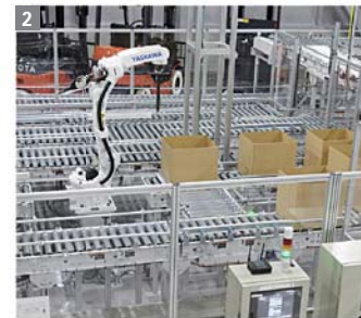
2 ピッキングソリューション 自動倉庫から出庫後、バラ品のピッキングを高速ピッキングロボットが自動で行います。
